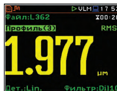
Измерение виброперемещения с применением фильтра Dil10
