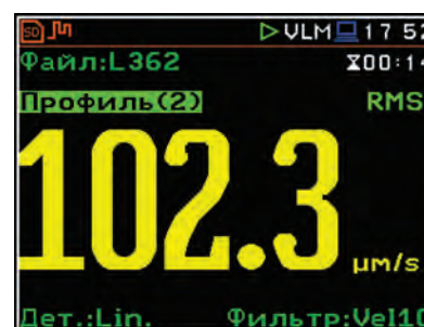
Измерение виброскорости с применением фильтра Vel10
