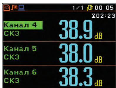
Измерение в режиме ВИБРОМЕТР по трем каналам
