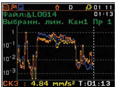
Форма представления ИСТОРИИ измерения на экране прибора. Возможно одновременно выводить истории измерения двенадцати ОСНОВНЫХ РЕЗУЛЬТАТОВ.
