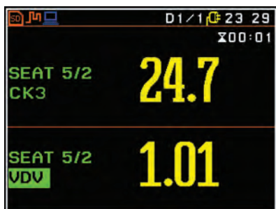
Отображение результата вычисления SEAT на дисплее прибора
